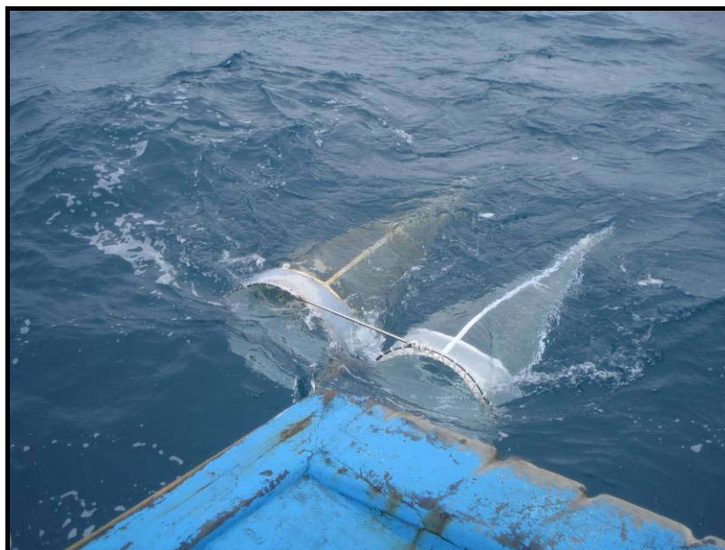
Figura 3.2.7: Lançamento das redes de 330 \mu m e 500 \mu m (Bongô) para coleta de ictioplâncton.
