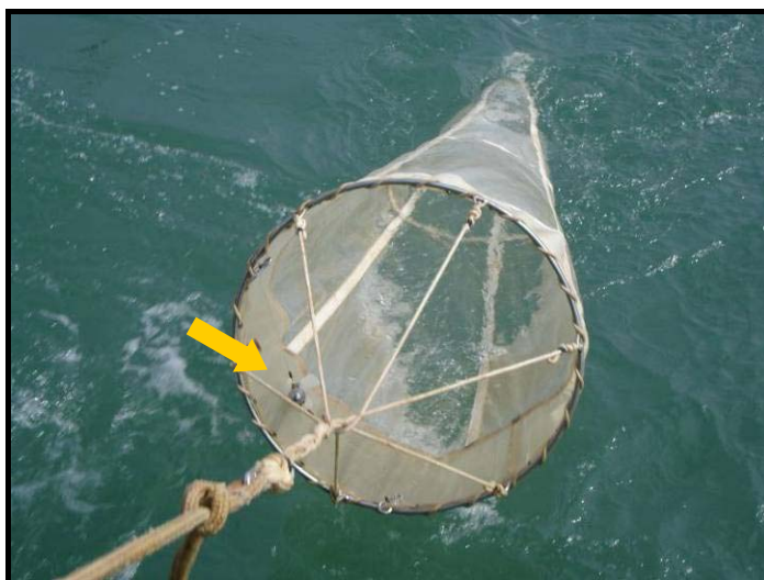
Figura 3.2.5: Lançamento da rede de 200 \mu\text{m} para coleta de zooplâncton. A seta amarela indica o fluxômetro acoplado à rede para estimar o volume de água filtrada.
