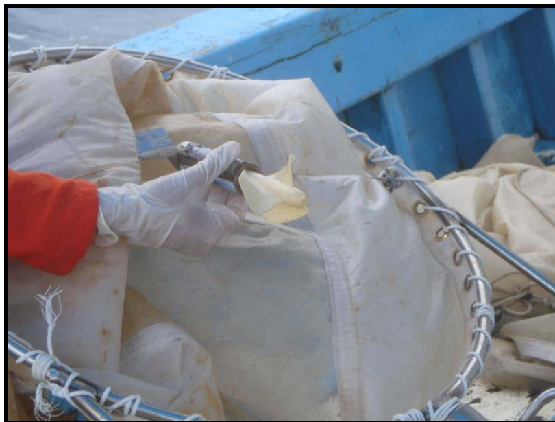
Figura 3.2.6: Leitura do fluxômetro para estimativa do volume de água filtrada pela rede durante o arrasto.
